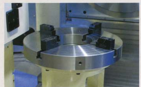
0.00001°の割り出しが可能な超精密インデックステーブル
