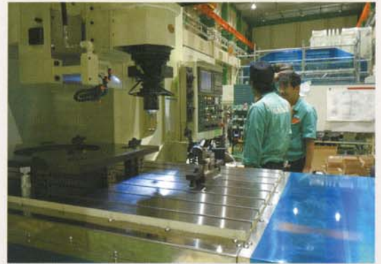
加工部とムーア社製の治具研削ユニット
