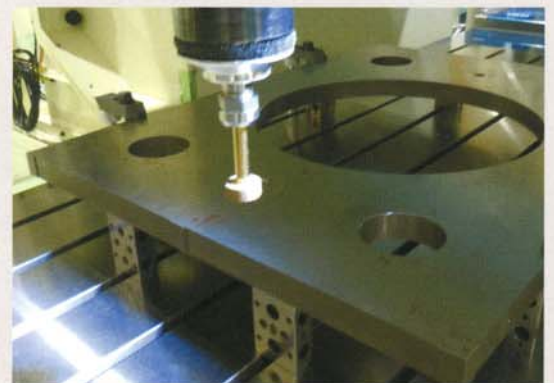
X、Y、C軸の同時制御により従来にないサイズの治具研削を実現
