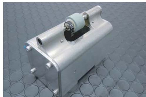
小型サイズの直交ロータリドレッサ Compact right-angle rotary dresser
